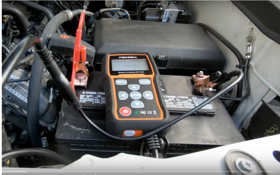
รูปที่2 แสดงการเชื่อมต่อขั้วแบตเตอรี่กับเครื่องมือวัด
