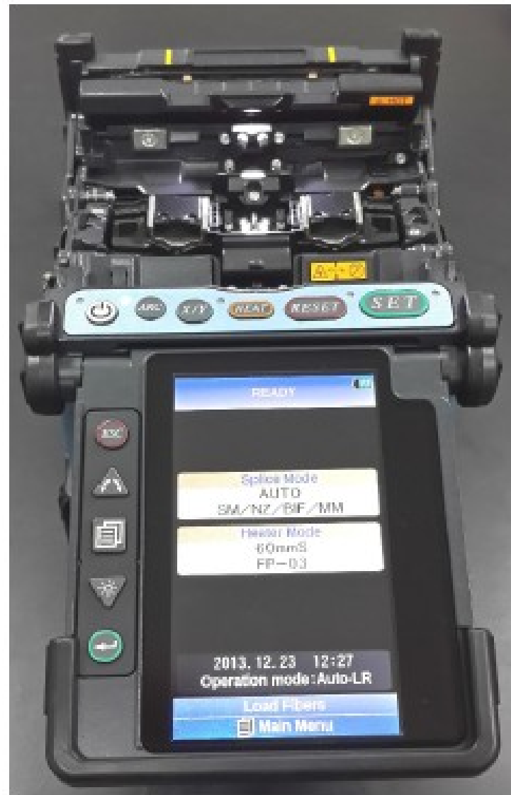
ภาพที่ 10.24: ตัวอย่างเครื่องเชื่อมต่อสายใยแก้วนำแสงด้วยการหลอมละลาย
