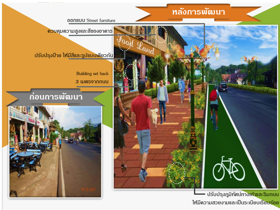
ภาพประกอบที่ 5.3 แสดงการพัฒนาพื้นที่ตามแนวคิดผังเมืองเฉพาะชุมชนเกาะช้าง : ทัศนียภาพของเมืองและที่เว้นว่างริมถนน
