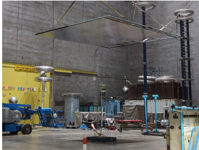
ก) ทดสอบด้วยเครื่องกำเนิดอิมพัลส์ไฟฟ้า
