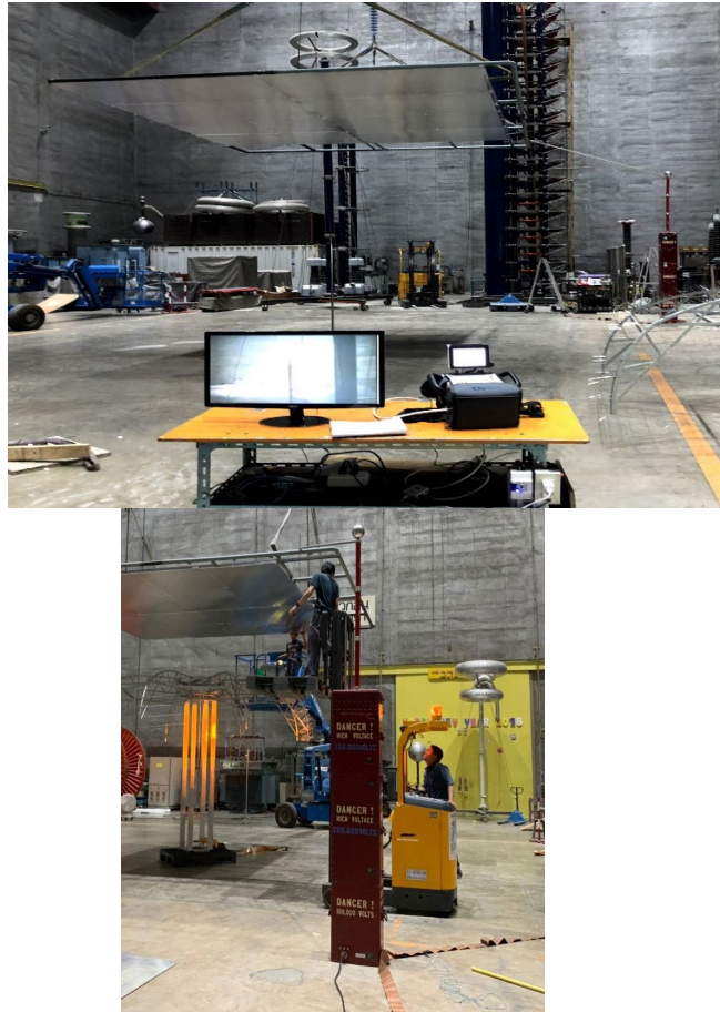
รูปที่ 3 การทดสอบแรงดันโคโรนาเริ่มเกิดของตัวนำล่อฟ้า ด้วยเครื่องกำเนิดแรงดันสูงกระแสตรงชั่วลบ
