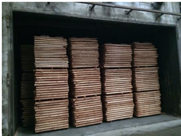
ภาพประกอบที่ 1.6 เตาอบและไม้สำหรับเตรียมอบ
