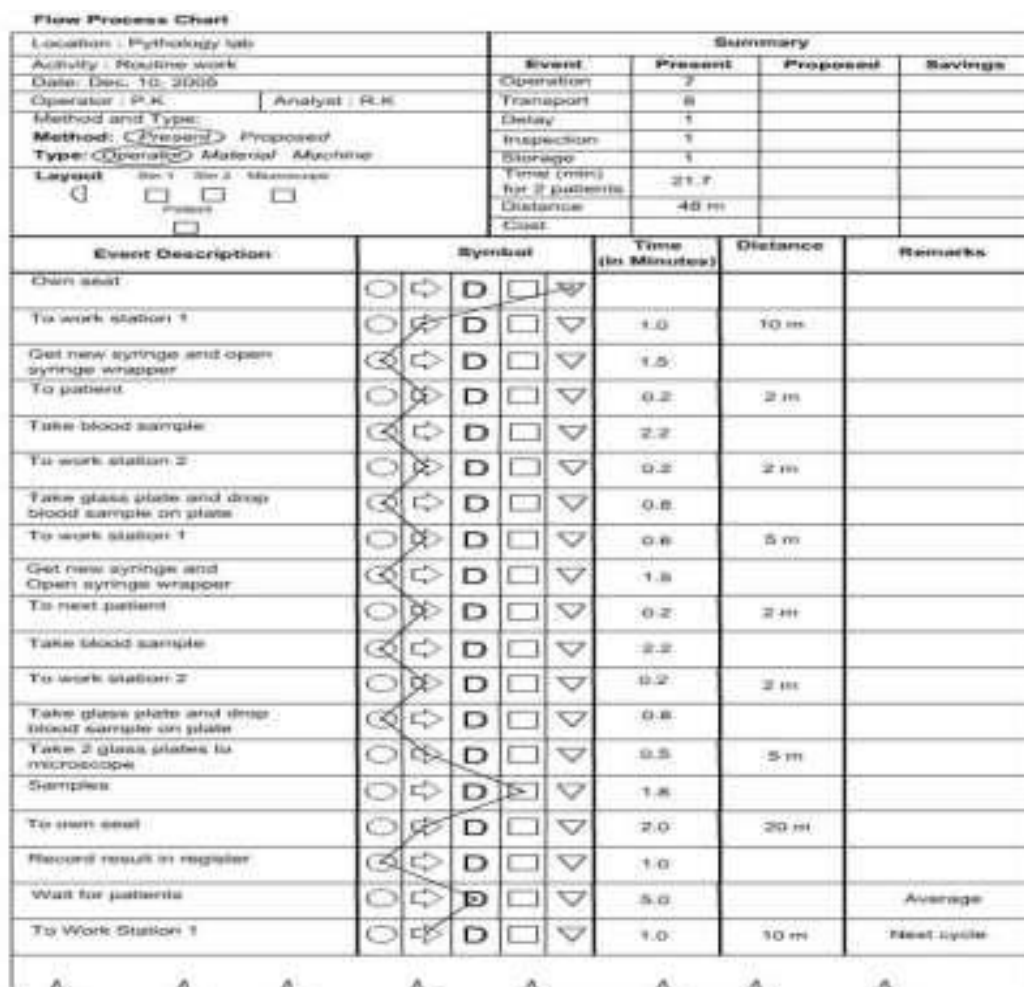
ภาพประกอบที่ 8 การทำแผนภูมิกระบวนการไหลของกระบวนการผลิต (Flow Process chart)
