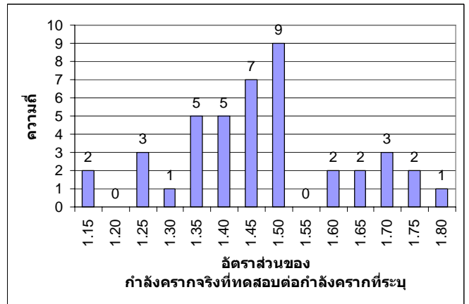
ภาพที่ 1 แผนภูมิแท่งความถี่แบ่งตามอัตราส่วนของกำลังครากจริงต่อกำลังครากที่ระบุ ของเหล็กเส้น RB6 จำนวน 42 ตัวอย่าง
