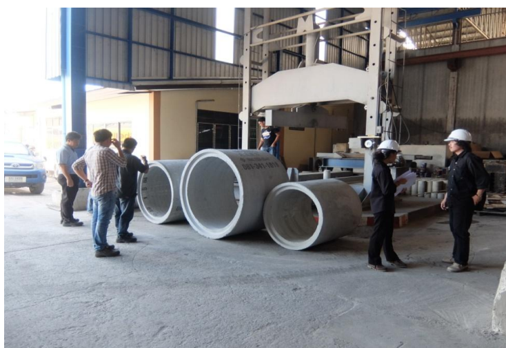
รูปที่ 3.2 ท่อระบายน้ำคอนกรีตเสริมเหล็ก
