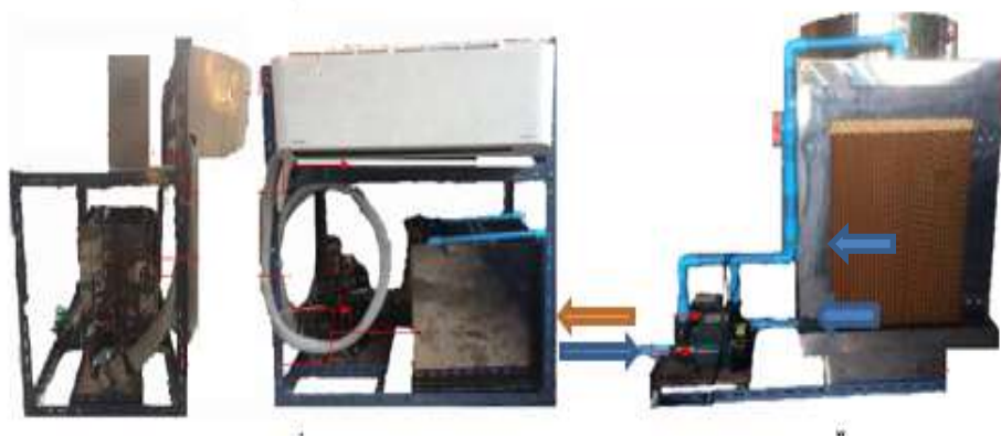
รูปที่ 3 ชุดระบบปรับอากาศและชุดระบายความร้อนด้วยน้ำแบบจุ่ม
