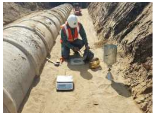
งาน Field Density Test ทรายถมข้างท่อ กม. 25+380 LT
