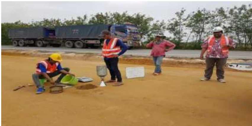
รูปที่ 3.9 ขั้นตอนการทดสอบระดับชั้นทราয় : ทดสอบไม่ผ่านต้องแก้Solif
