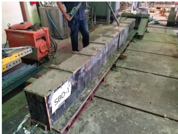
รูปที่ 3.1.19 การแต่งผิวหน้าคาน
