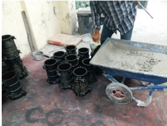
รูปที่ 3.1.113 การเตรียมแบบหล่อ
