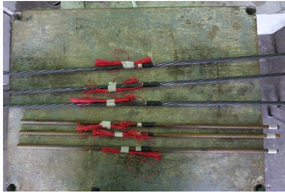
รูปที่ 3.2.1 การติดตั้ง Strain gauge ที่เหล็กเสริม
