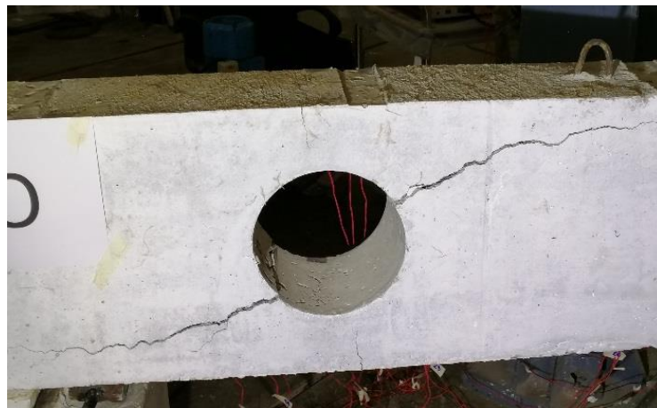
รูปที่ 4.2.10 เกิดการวิบัติโดยรูปแบบการวิบัติแบบ Flexure Failure
