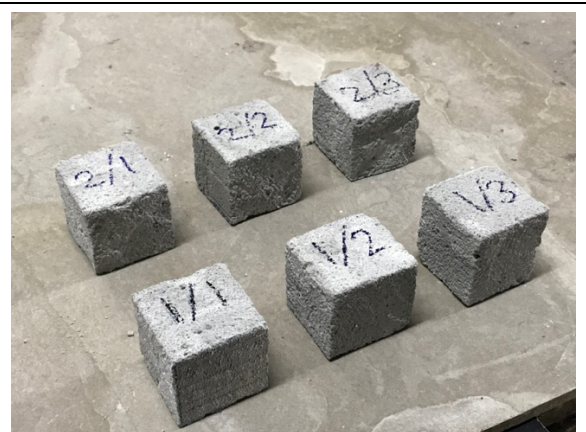
2. นำชิ้นทดสอบมาเช็ดให้อยู่ในสภาพผิวที่แห้ง
