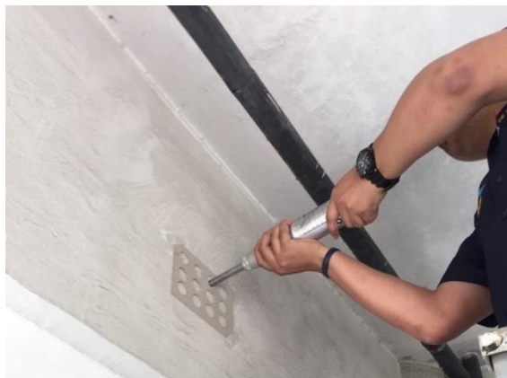
ภาพที่ 4.2 แสดงตัวอย่างการทดสอบโครงสร้างแบบไม่ทำลายด้วยมมทดสอบ A
