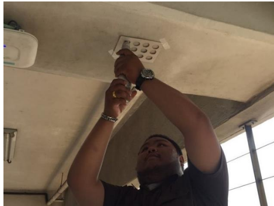
ภาพที่ 4.1 แสดงตัวอย่างการทดสอบโครงสร้างแบบไม่ทำลายด้วยมมทดสอบ C
