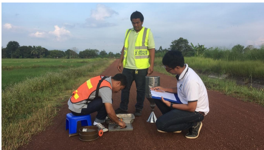
รูปที่ จ-7 ทำการเจาะผิวทางเพื่อหาความแน่นภาคสนาม
