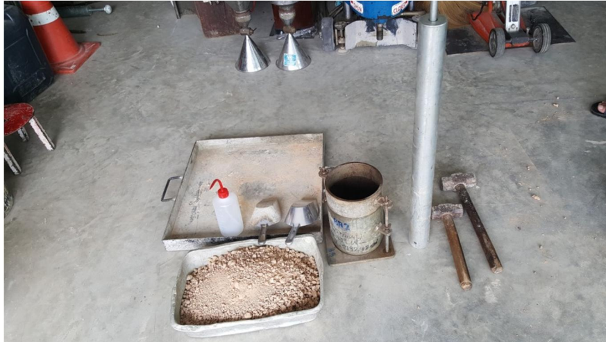
(ก.) เตรียมอุปกรณ์ตามมาตรฐาน ทล.-ท. 108/251, มทช.(ท) 501.2 -2545
