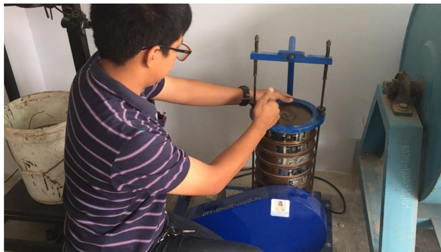
รูปที่ จ-4 ทำติดตั้งตะแกรงทดสอบกับเครื่องเขย่า
