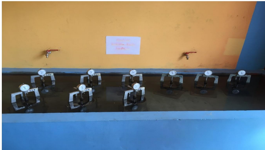
รูปที่ 3.12 ตัวอย่างการทดสอบความทนทานต่อสภาวะน้ำท่วมรูปแบบที่ 1 แชน้ำ (Soaked) 4 วัน
