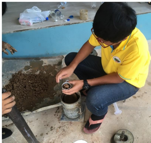
(ก.) ทำการบดอัดตัวอย่างตามมาตรฐานการทดสอบ (ข.) เก็บตัวอย่างไปอบเพื่อหาค่าความชื้นในดิน
