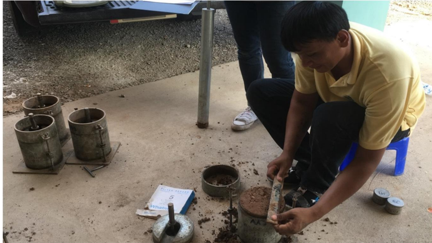
(ก.) ทำการแต่งผิวหนังจากการบดอัดตามมาตรฐาน ทล.-ท. 109/2517, มทช.(ท) 501.3 - 2545
