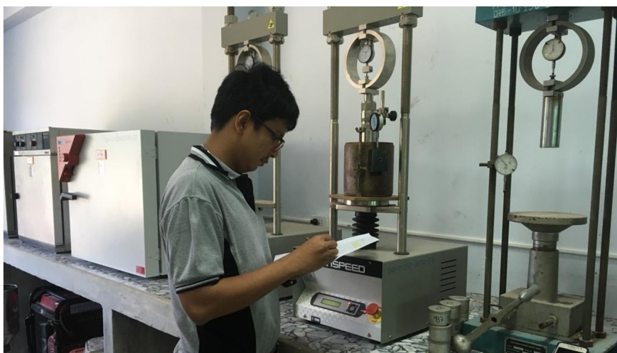
รูปที่ จ-10 ทำการกดตัวอย่างดินลูกรังชั้นผิวทางเดิมเพื่อนำมาคำนวณหาค่า % CBR เพื่อนำผลไปเทียบกับมาตรฐานรองพื้นทาง
