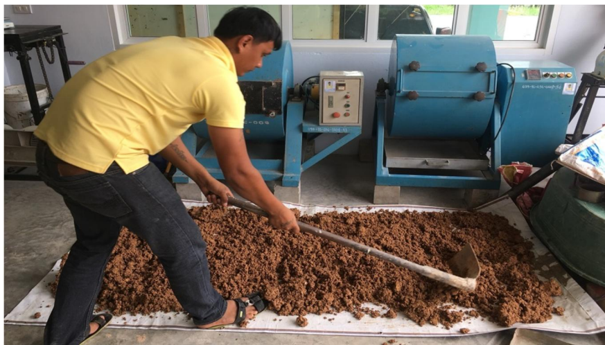
(ก.) นำตัวอย่างดินลูกรังชั้นผิวทางเดิมมาผึ่งที่อุณหภูมิห้อง
