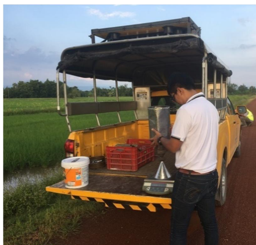
(ข.) ทำการชั่งน้ำหนักทรายที่เหลือในกรวย
