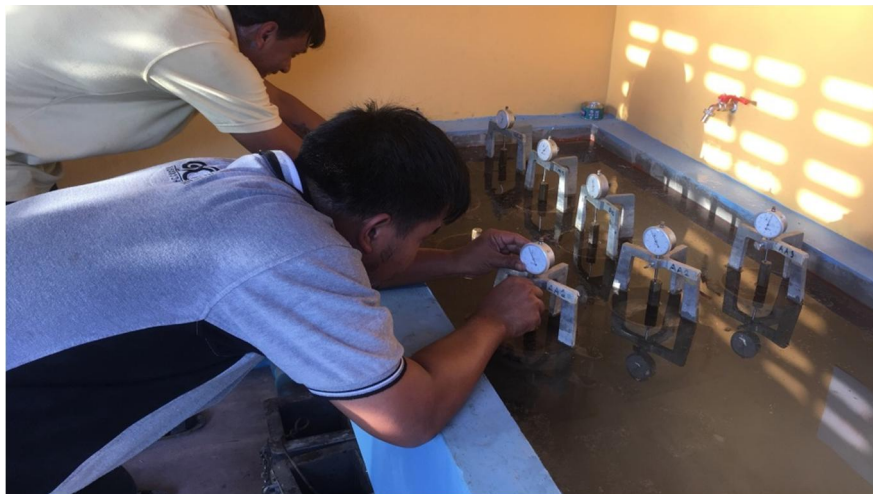
(ข.) นำตัวอย่างแช่น้ำและติดตั้ง Dial gauge
