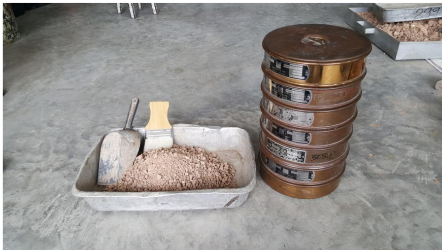
(ก.) เตรียมตัวอย่างและอุปกรณ์ตามมาตรฐาน ทล.-ท. 204/2516 , มทช.(ท) 501.8 - 2545
