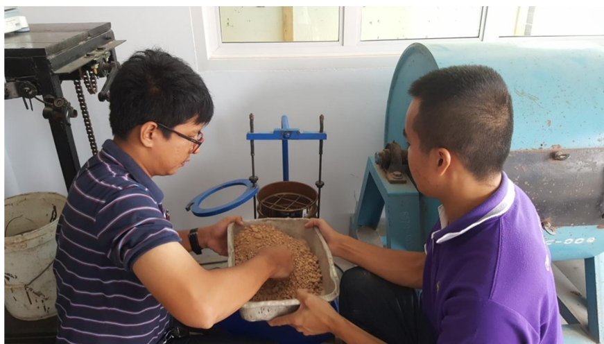
(ข.) นำตัวอย่างที่เตรียมไว้ใส่ลงในเครื่องเขย่าตะแกรง
