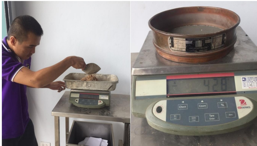
รูปที่ จ-3 ทำการชั่งน้ำหนักดินตัวอย่างและตะแกรงก่อนทำการทดสอบ Sieve Analysis
