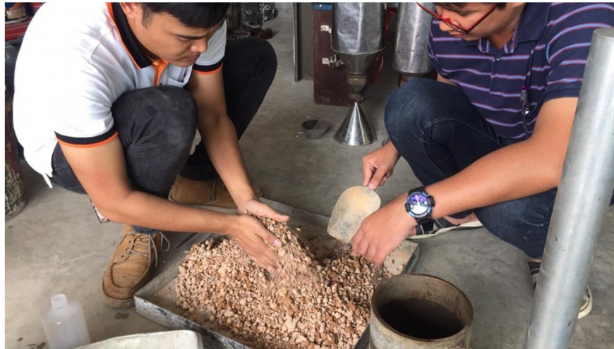
รูปที่ จ-5 ผสมดินลูกรังชั้นพื้นทางเดิมที่เตรียมไว้กับน้ำ
