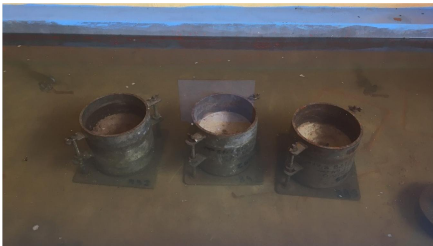
รูปที่ จ-9 การทดลองเพื่อหาค่า CBR
