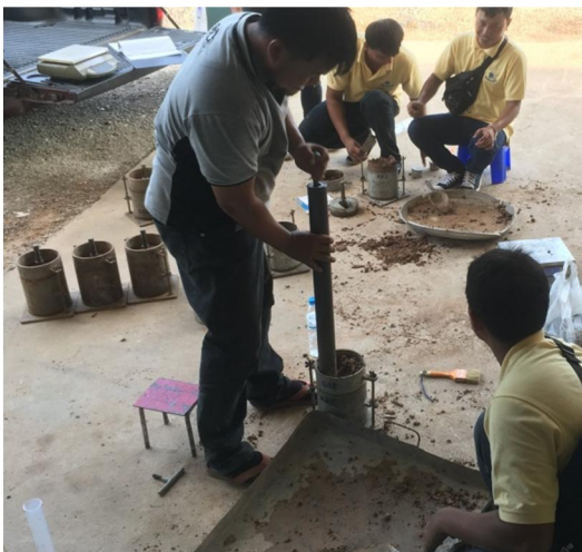
(ก.) ทำการบดอัดตัวอย่างตามมาตรฐานการทดสอบ (ข.) เก็บตัวอย่างไปอบเพื่อหาค่าความชื้นในดิน
