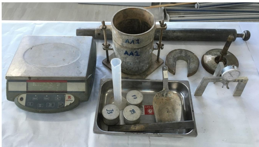
รูปที่ 3.8 อุปกรณ์การทดสอบเพื่อหาค่า CBR ตามมาตรฐานทล.-ท. 109/251, มทช.(ท) 501.3 - 2545
