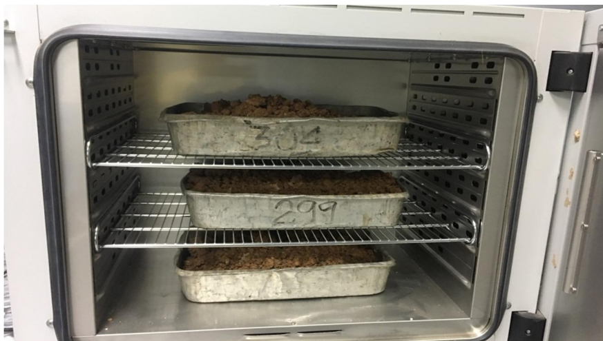
(ข.) ทำการอบตัวอย่าง 24 ชม. ก่อนนำไปทำการทดสอบ
