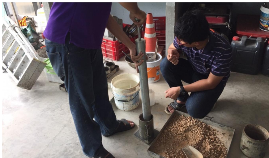
รูปที่ จ-6 ทำการบดอัดจำนวน 5 ชั้น ชั้นละ 25 ครั้ง โดยเพิ่มน้ำขึ้น 2% จนกว่าจะได้ความหนาแน่น ลดลงจึงหยุดการทดลอง
