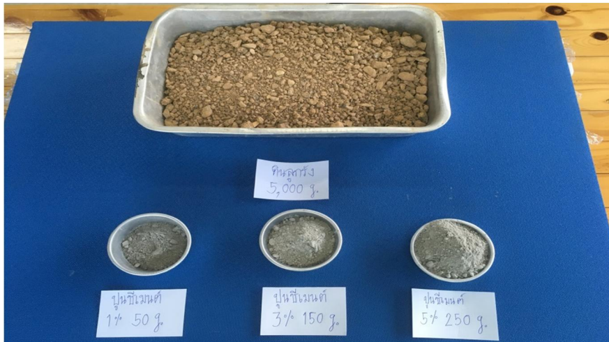
(ข.) การเตรียมอัตราส่วนผสมของตัวอย่าง Soil Cement
