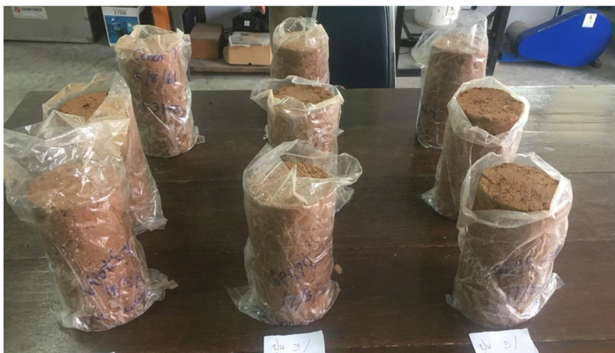
รูปที่ จ-11 การเตรียมตัวอย่างทดสอบ UCS. ของ Soil Cement ที่อัตราส่วนผสมของ Cement เท่ากับ 1, 3 และ 5 % เพื่อใช้หาอัตราส่วนที่เหมาะสม บ่มในถุงพลาสติกใช้เวลาในการบ่ม 7 วัน
