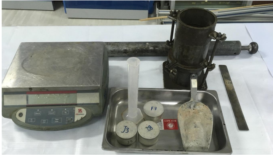
(ก.) เตรียมอุปกรณ์ทดสอบตามมาตรฐาน ทล.-ท.105/2515
