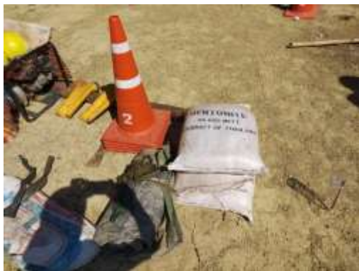
รูปที่ ข.19 เครื่องมือและวัสดุการทดสอบ SPT
