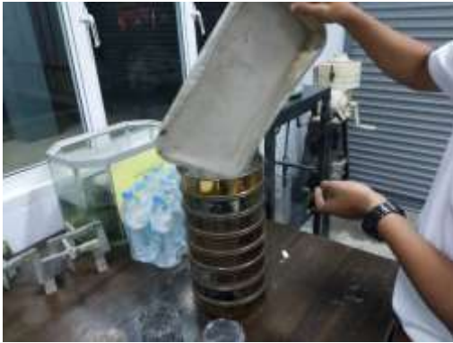
รูปที่ ข.15 การทดสอบหาค่า Sieve Analysis
