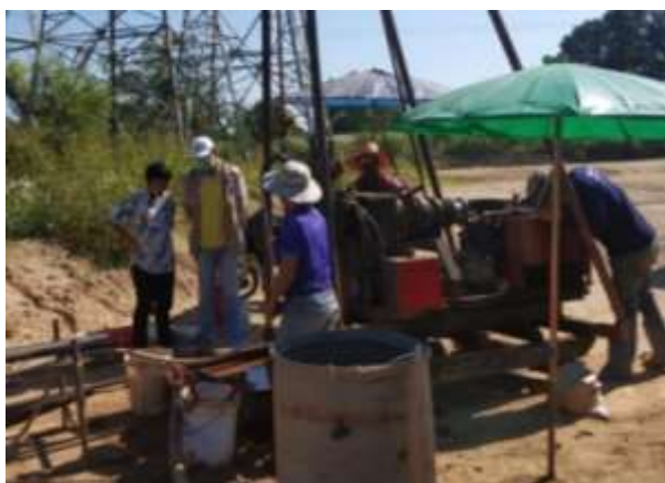
รูปที่ 2.2 การทดสอบตอกทะลวงมาตรฐาน Standard Penetration Test
