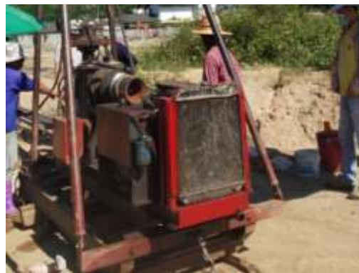
รูปที่ ข.20 การทดสอบ SPT ในสนาม
