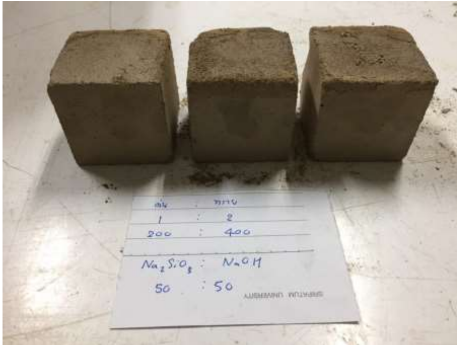
รูปที่ ก.13 ลักษณะทางกายภาพของการขึ้นรูปจีโอพอลิเมอร์ในอัตราส่วน ตะกอนดินประปา : สารละลาย : ทราย เท่ากับ 1.00:0.45:2.00 \text{Na}_2\text{SiO}_3 : \text{NaOH} เท่ากับ 50:50 โดยน้ำหนัก
