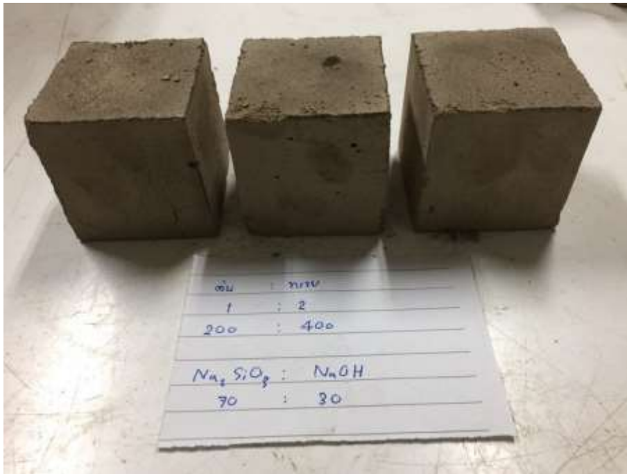
รูปที่ ก.15 ลักษณะทางกายภาพของการขึ้นรูปจีโอพอลิเมอร์ในอัตราส่วน ตะกอนดินประปา : สารละลาย : ทราช เท่ากับ 1.00:0.45:2.00 \text{Na}_2\text{SiO}_3 : \text{NaOH} เท่ากับ 70:30 โดยน้ำหนัก
