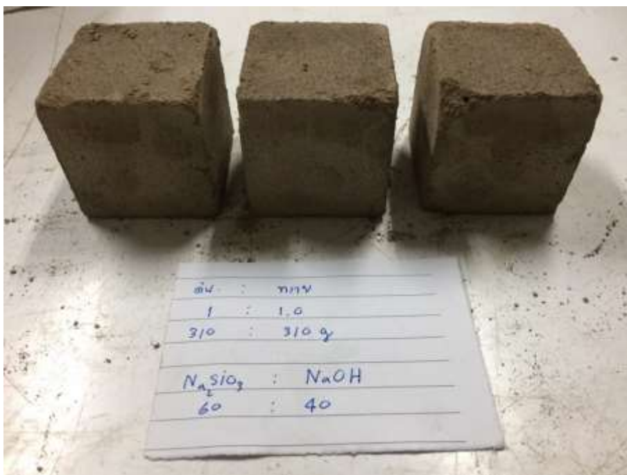
รูปที่ ก.6 ลักษณะทางกายภาพของการขึ้นรูปจีโอพอลิเมอร์ในอัตราส่วน ตะกอนดินประปา : สารละลาย : ทราย เท่ากับ 1.00:0.45:1.10 \text{Na}_2\text{SiO}_3 : \text{NaOH} เท่ากับ 60:40 โดยน้ำหนัก
