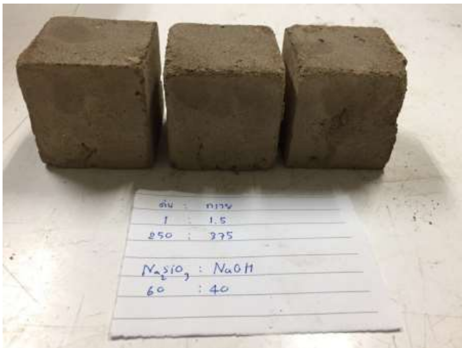
รูปที่ ก.10 ลักษณะทางกายภาพของการขึ้นรูปจีโอพอลิเมอร์ในอัตราส่วน ตะกอนดินประปา : สารละลาย : ทราย เท่ากับ 1.00:0.45:1.50 \text{Na}_2\text{SiO}_3 : \text{NaOH} เท่ากับ 60:40 โดยน้ำหนัก
