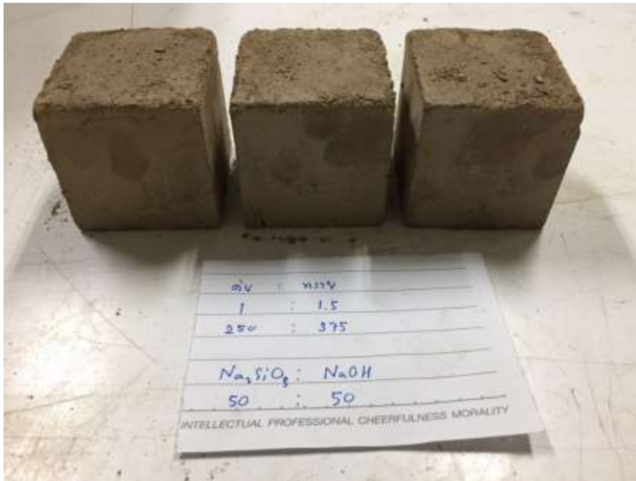
รูปที่ ก.9 ลักษณะทางกายภาพของการขึ้นรูปจีโอพอลิเมอร์ในอัตราส่วน ตะกอนดินประปา : สารละลาย : ทราย เท่ากับ 1.00:0.45:1.50 \text{Na}_2\text{SiO}_3 : \text{NaOH} เท่ากับ 50:50 โดยน้ำหนัก
