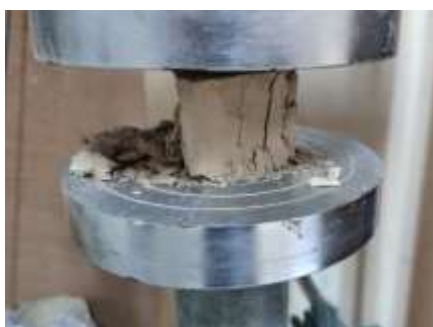
รูปที่ 3.7 ทดสอบการรับกำลังอัด
