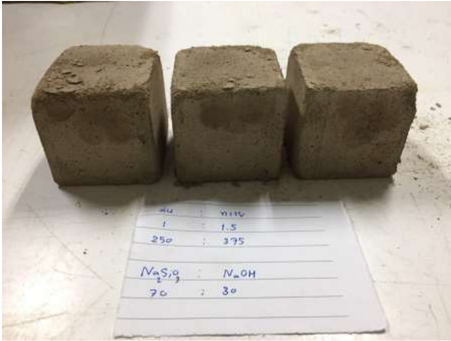
รูปที่ ก.11 ลักษณะทางกายภาพของการขึ้นรูปจีโอพอลิเมอร์ในอัตราส่วน ตะกอนดินประปา : สารละลาย : ทราย เท่ากับ 1.00:0.45:1.50 \text{Na}_2\text{SiO}_3 : \text{NaOH} เท่ากับ 70:30 โดยน้ำหนัก
