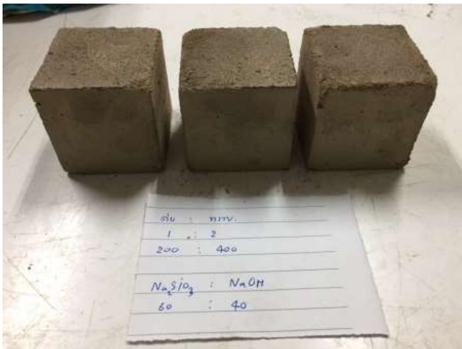
รูปที่ ก.14 ลักษณะทางกายภาพของการขึ้นรูปจีโอพอลิเมอร์ในอัตราส่วน ตะกอนดินประปา : สารละลาย : ทราย เท่ากับ 1.00:0.45:2.00 \text{Na}_2\text{SiO}_3 : \text{NaOH} เท่ากับ 60:40 โดยน้ำหนัก
