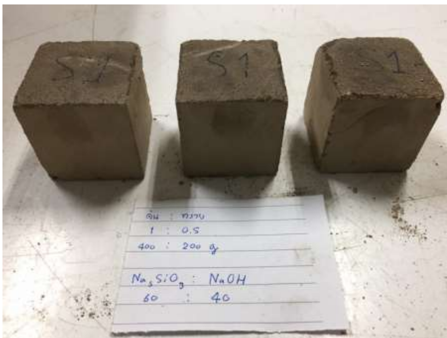
รูปที่ ก.2 ลักษณะทางกายภาพของการขึ้นรูปจีโอพอลิเมอร์ในอัตราส่วน ตะกอนดินประปา : สารละลาย : ทราว เท่ากับ 1.00:0.45:0.50 \text{Na}_2\text{SiO}_3 : \text{NaOH} เท่ากับ 60:40 โดยน้ำหนัก
