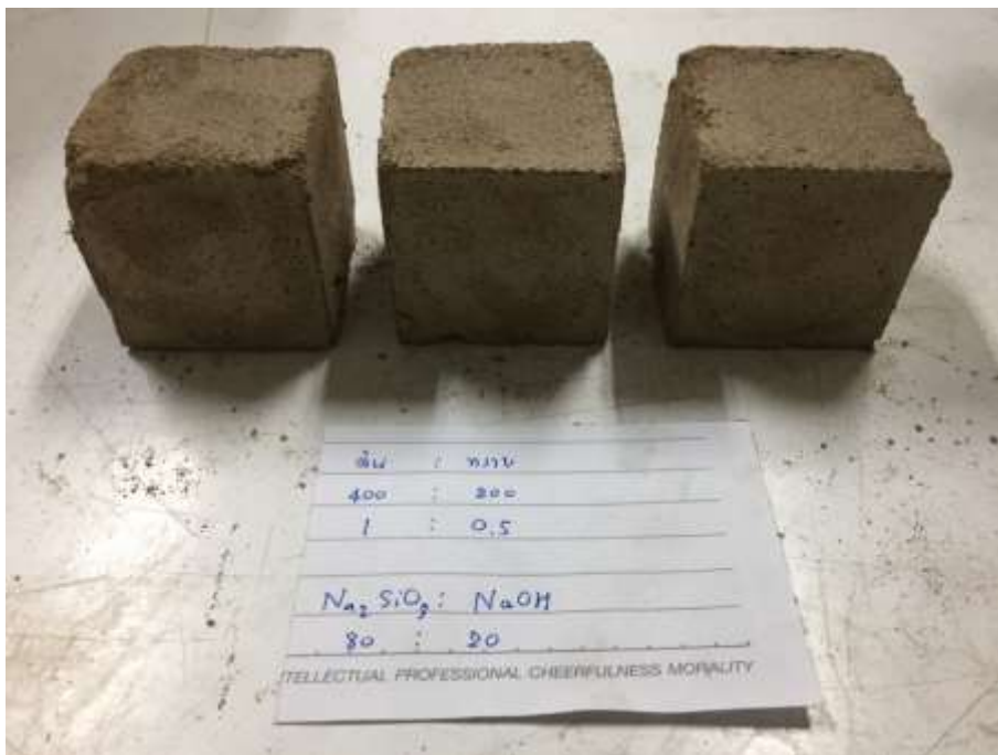
รูปที่ ก.4 ลักษณะทางกายภาพของการขึ้นรูปจีโอพอลิเมอร์ในอัตราส่วน ตะกอนดินประปา : สารละลาย : ทราย เท่ากับ 1.00:0.45:0.50 \text{Na}_2\text{SiO}_3 : NaOH เท่ากับ 80:20 โดยน้ำหนัก
