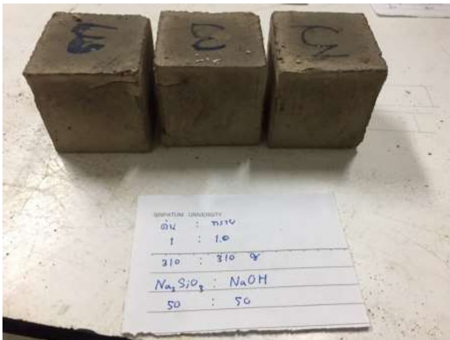
รูปที่ ก.5 ลักษณะทางกายภาพของการขึ้นรูปจีโอพอลิเมอร์ในอัตราส่วน ตะกอนดินประปา : สารละลาย : ทราย เท่ากับ 1.00:0.45:1.00 \text{Na}_2\text{SiO}_3 : \text{NaOH} เท่ากับ 50:50 โดยน้ำหนัก
