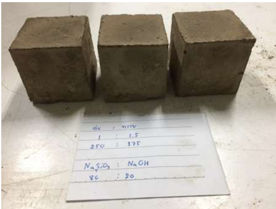
รูปที่ ก.12 ลักษณะทางกายภาพของการขึ้นรูปจีโอพอลิเมอร์ในอัตราส่วน ตะกอนดินประปา : สารละลาย : ทราย เท่ากับ 1.00:0.45:1.50 \text{Na}_2\text{SiO}_3 : \text{NaOH} เท่ากับ 80:20 โดยน้ำหนัก
