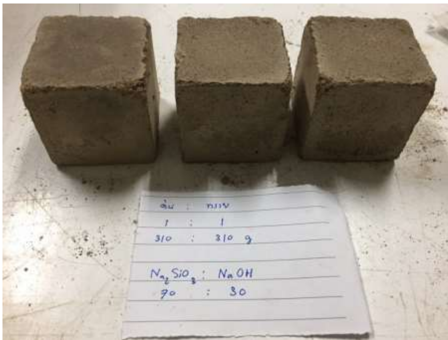
รูปที่ ก.7 ลักษณะทางกายภาพของการขึ้นรูปจีโอพอลิเมอร์ในอัตราส่วน ตะกอนดินประปา : สารละลาย : ทราย เท่ากับ 1.00:0.45:1.00 \text{Na}_2\text{SiO}_3 : \text{NaOH} เท่ากับ 70:30 โดยน้ำหนัก
