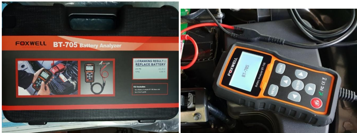
รูปที่ 3.2 เครื่องมือวัดค่าแบตเตอรี่ Foxwell
