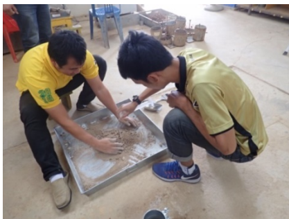
รูปที่ 4.12 การทดสอบ Standard Proctor Test
