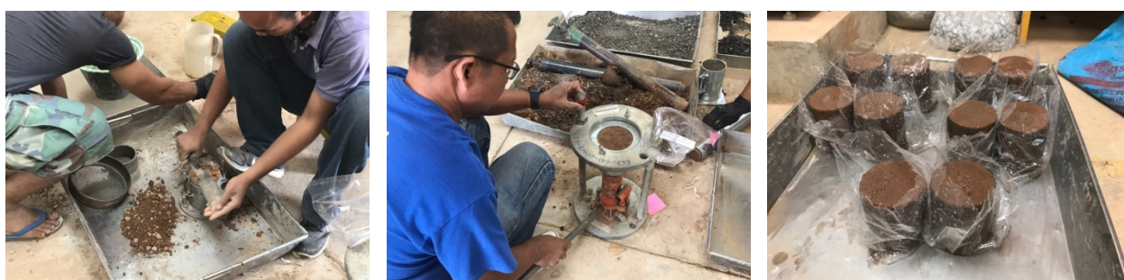
รูปที่ 4.14 การเก็บตัวอย่างก่อนทดสอบ Unconfined Compressive Strength
