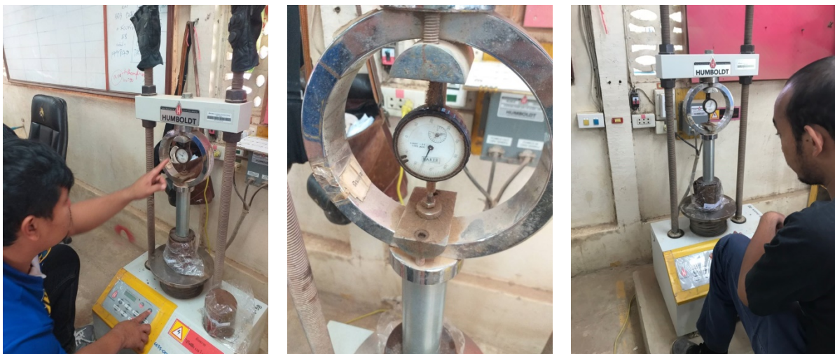
รูปที่ 4.16 การทดสอบ Unconfined Compressive Strength
