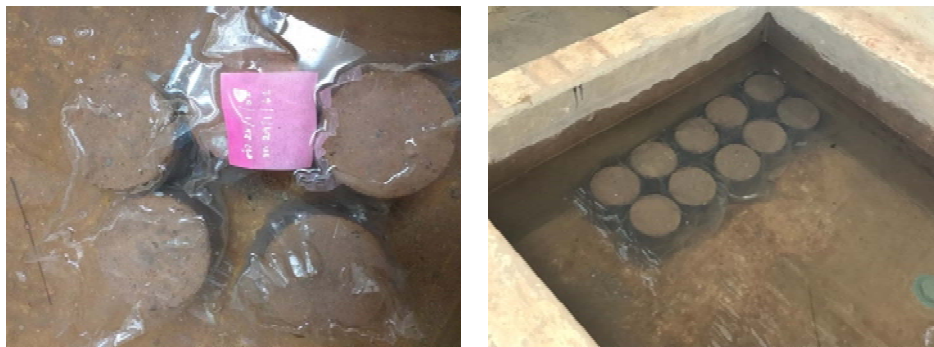
รูปที่ 4.15 รูปการแช่ตัวอย่างการทดสอบ Unconfined Compressive Strength ก่อนนำไปทดสอบ 2 ชั่วโมง
