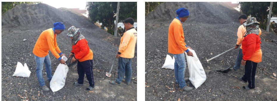
รูปที่ 4.10 การเก็บตัวอย่างวัสดุวัสดุากยางแอสฟัลต์ (Milling Asphalt) เพื่อใช้ในการทดสอบ
