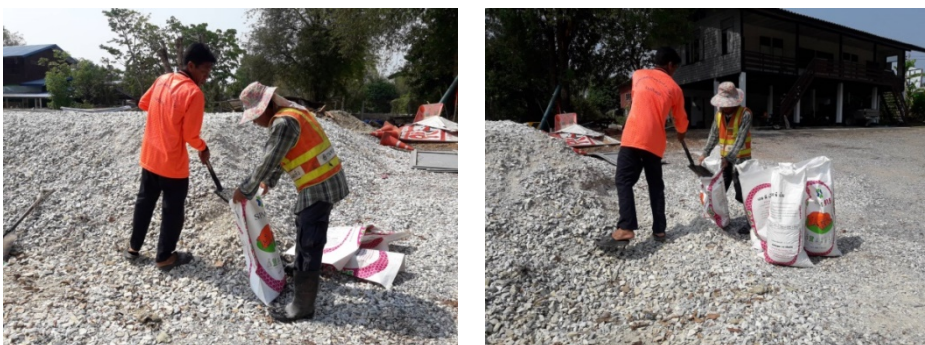
รูปที่ 4.9 การเก็บตัวอย่างวัสดุหินคลุกเพื่อใช้ในการทดสอบ
