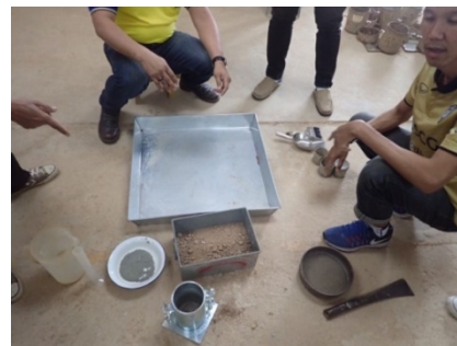
รูปที่ 4.12 การทดสอบ Standard Proctor Test
