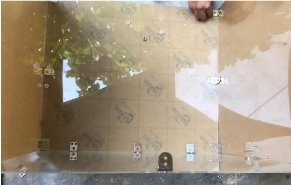
รูปที่ 3.9 แสดงลักษณะการยึดโดยการใช้นากสามจุด
