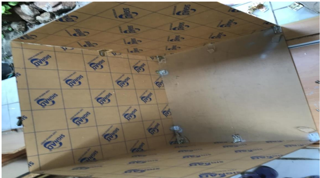
รูปที่ 3.10 แสดงลักษณะการประกอบแผ่นอะคริลิกแบบกล่อง
