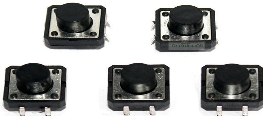
ภาพที่ 2.24 แสดงลักษณะสวิตช์ กดติดปล่อยดับ
