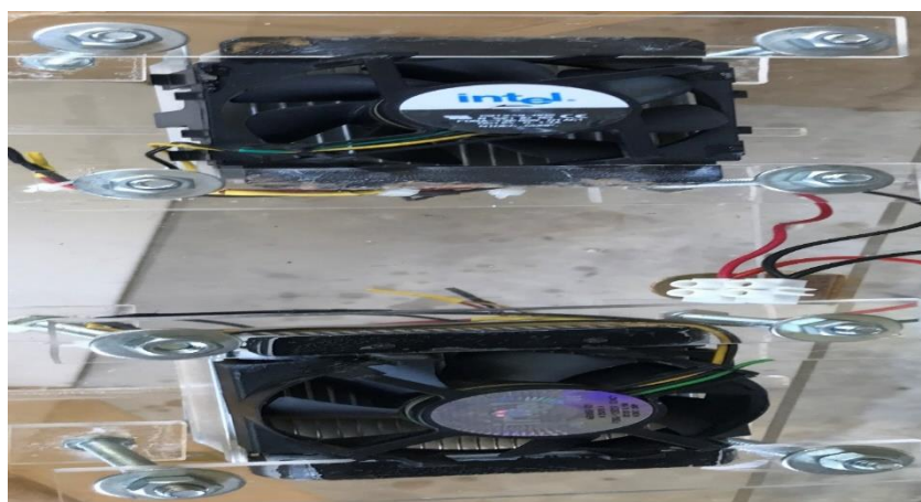
ภาพที่ 3.12 แสดงลักษณะของการประกอบเพลทเทอร์เข้ากับอะคริลิก
