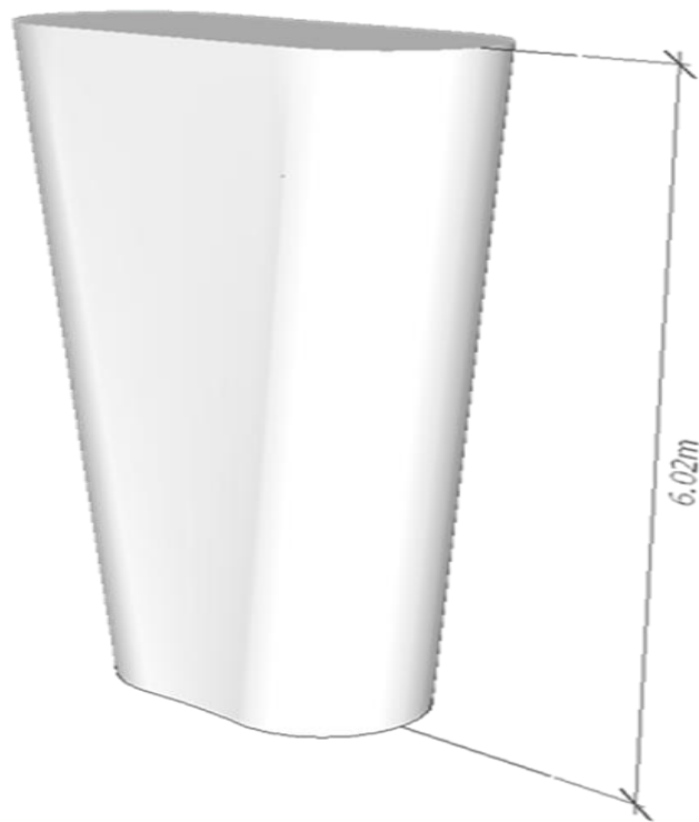
รูปที่ ข 8 โมเดลคอนกรีตเสาทอม่อชนิด A1 ตำแหน่ง P4
