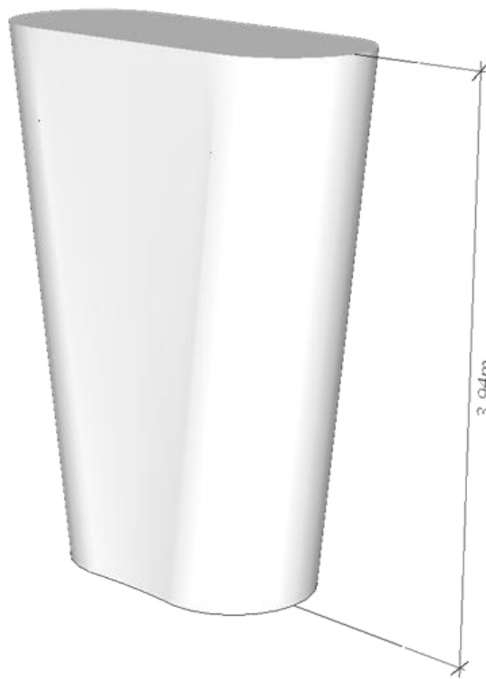
รูปที่ ข 20 โมเดลคอนกรีตเสาดม่อชนิด A1 ตำแหน่ง P10
