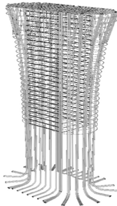
รูปที่ ข 21 โมเดลเหล็กเสริมเสาดม่อชนิด A1 ตำแหน่ง P10
