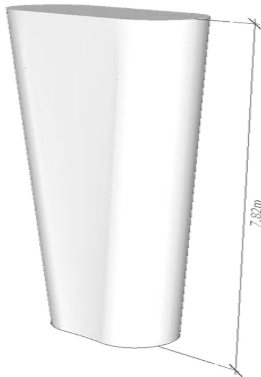
รูปที่ ข 14 โมเดลคอนกรีตเสาทอม่อชนิด A1 ตำแหน่ง P7
