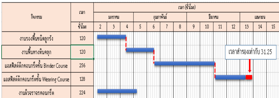
รูปที่ 4.8 แผนงานที่บวกเวลาสำรองด้วยการวิเคราะห์ วิธี เพิร์ท
