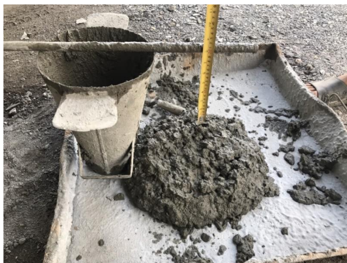
รูปที่ 4.13 แสดงการตรวจสอบค่ายุบตัวอยู่ที่ 17.5 \pm 2.5 เซนติเมตร
