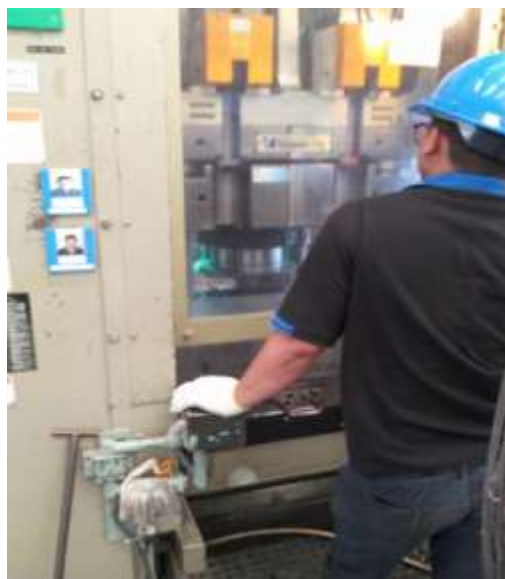
ภาพที่ 3.8 พนักงานทำการจับชิ้นงานลงแม่พิมพ์เพื่อขึ้นรูป
