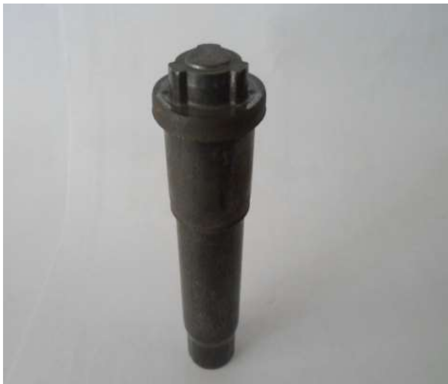
ภาพที่ 3.9 ชิ้นงานเหล็กแท่ง จากกระบวนการปั๊มขึ้นรูป
