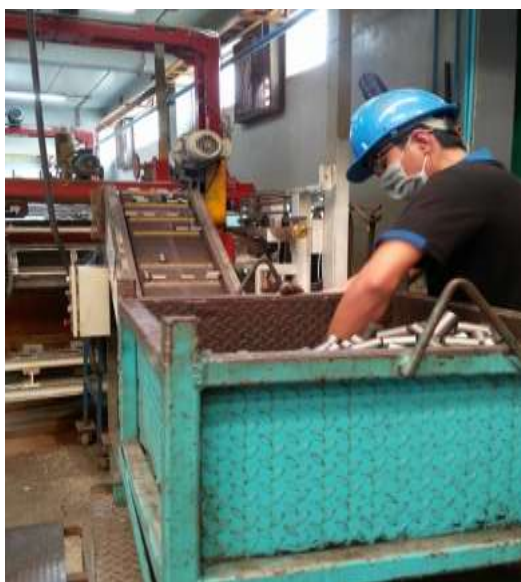
ภาพที่ 3.7 การนำชิ้นงานเข้าบ่อเพื่อทำการจับเวลาใส่มวลสาร
