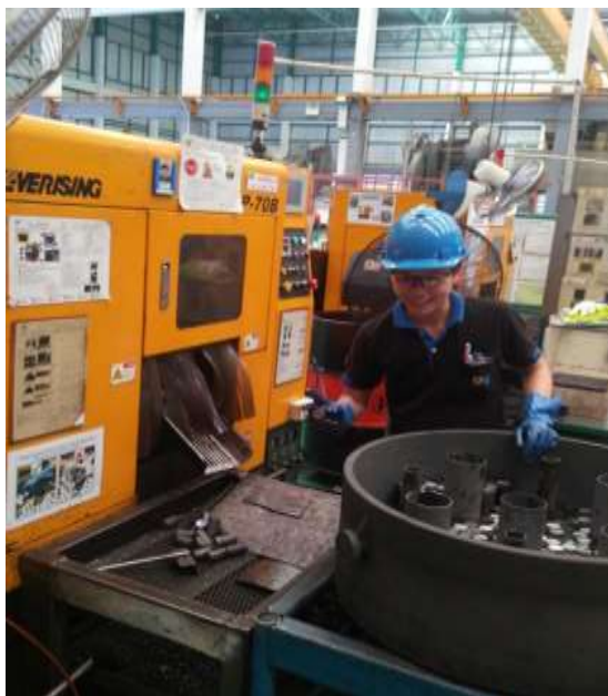
ภาพที่ 3.4 พนักงานจะนำวัสดุคืบเหล็กแท่งเข้าเครื่องตัดขึ้นงาน
