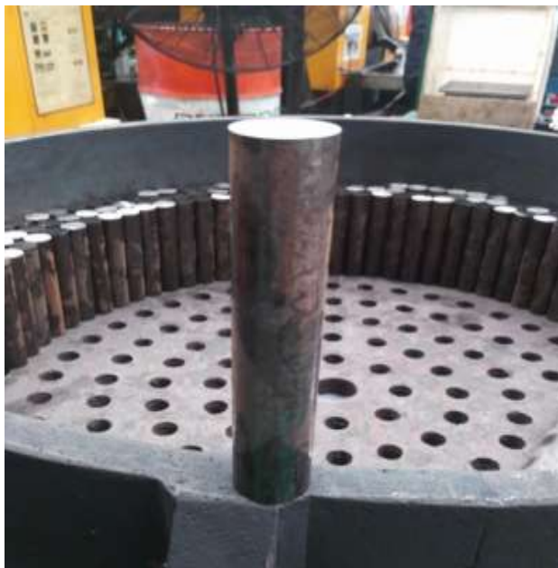
ภาพที่ 3.3 วัสดุคืบที่ทำการตัดออกมาจากเครื่องตัด
