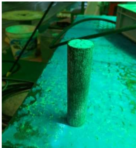
ภาพที่ 3.7 การนำชิ้นงานเข้าบ่อเพื่อทำการจับเวลาใส่มวลสาร
