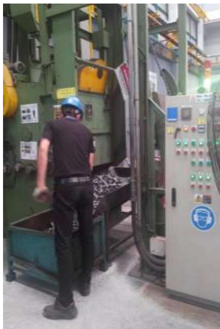
ภาพที่ 3.6 พนักงานนำชิ้นงานเข้าเครื่องคว่ำทราย
