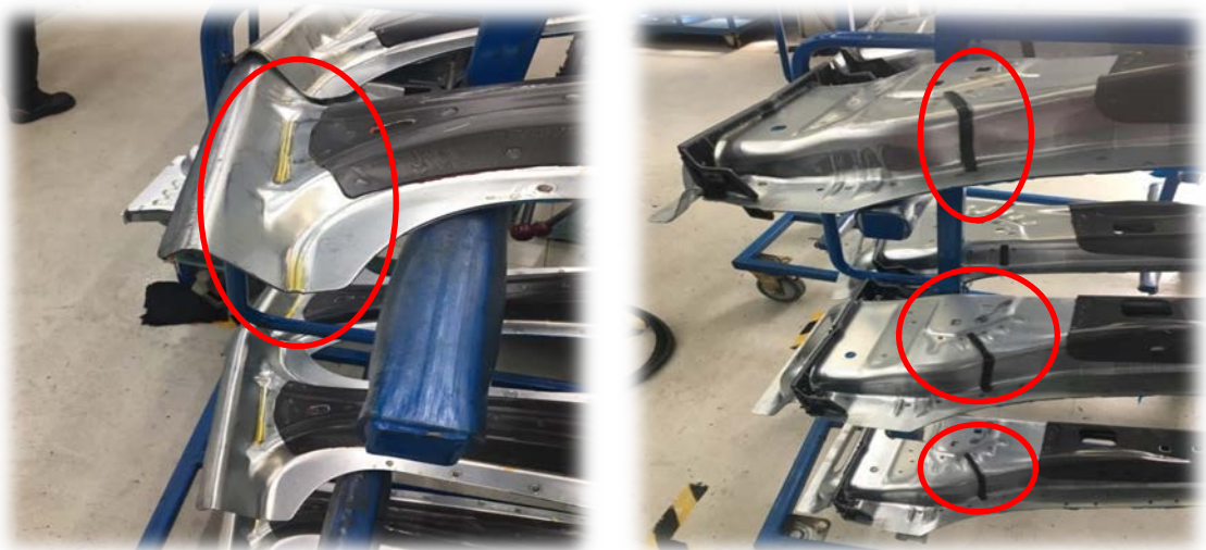
รูปที่ 4.2 พนักงานยังไม่ได้ทำความสะอาดเสาเอ รูปที่ 4.3 โฟมพาร์ทเป็นจุดเซฟตี้ของรถช่วยซับเสียง
