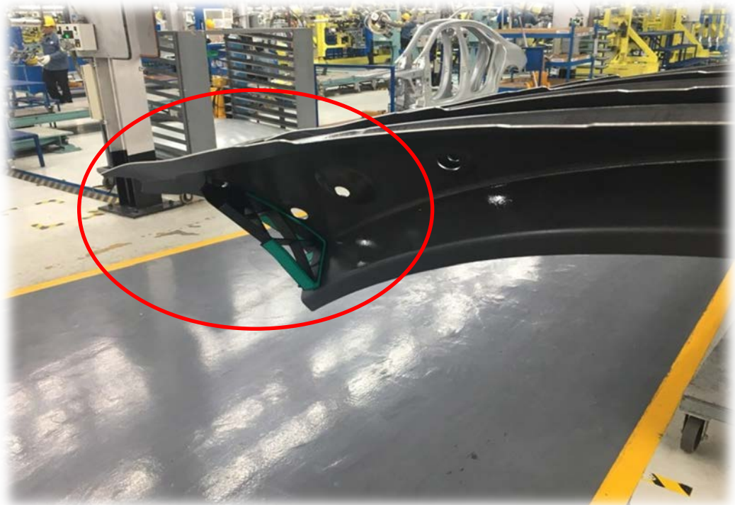
รูปที่ 4.4 โฟมพาร์ทช่วยในการซับเสียงและช่วยกันน้ำเข้ารถ
