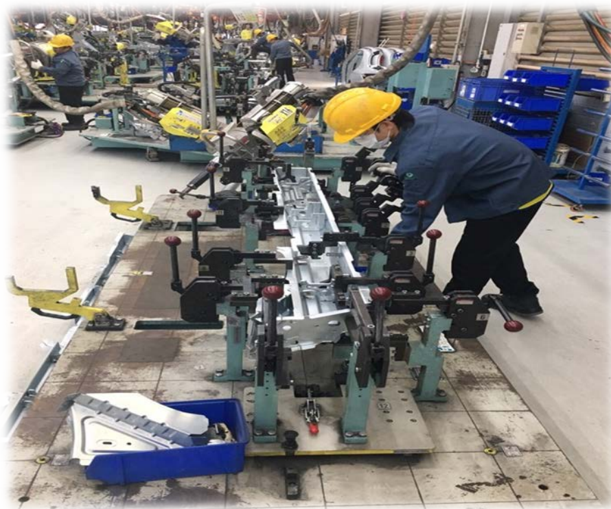
รูปที่ 4.6 พนักงานทำการยิงสปอตขึ้นงานคานรถ E-Class
