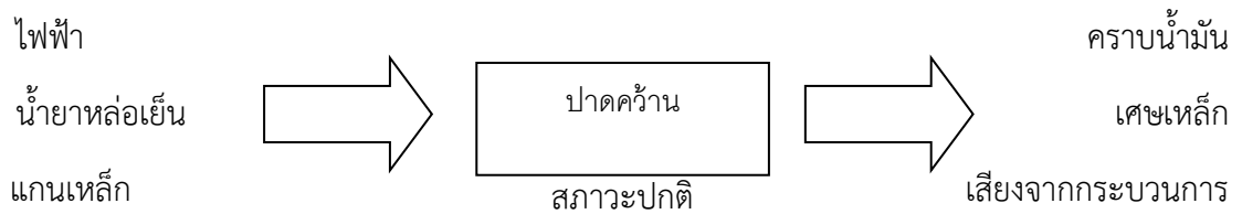
ภาพที่ 4.4 แสดงการปาดคว้านในสภาวะปกติของกระบวนการผลิตสายน้ำยาแอร์
