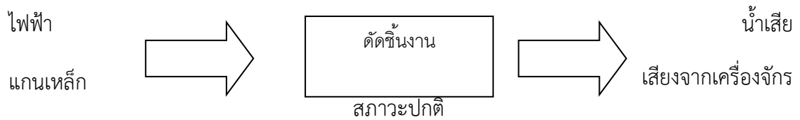
ภาพที่ 4.8 การแสดงการดัดชิ้นงานในสภาวะปกติในกระบวนการผลิตสายน้ำยาแอร์
