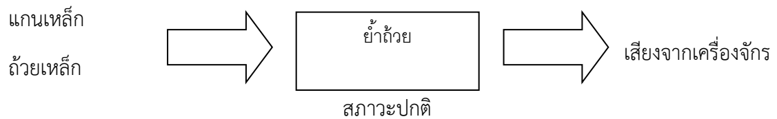
ภาพที่ 4.10 แสดงการย่ำถ้วยในสภาวะปกติในกระบวนการผลิตสายน้ำยาแอร์
