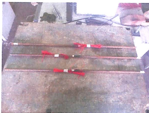
ภาพที่ 3.5 เหล็กเสริมไม่อัดแรง (DB12 mm. Grade SD40)
