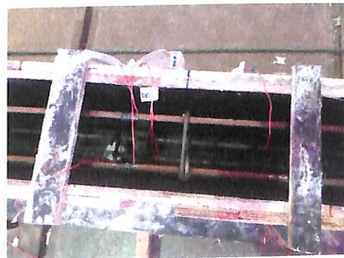
(b) strain gage ที่ติดกับเหล็กเสริมไม่อัดแรง
