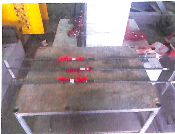
ภาพที่ 3.4 เหล็กเสริมอัดแรง(Strand 7 wire dia.12.7 mm. Grade 1860)
