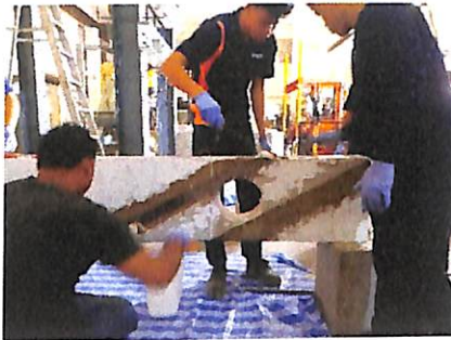
c) ทา SMART CF-Resin ทับแผ่น CFRP
