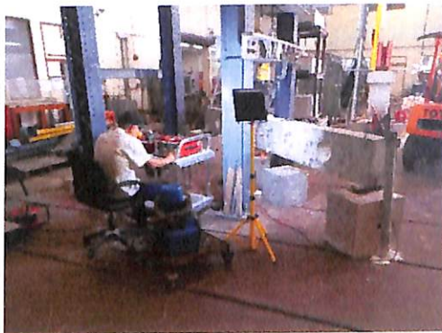
(b) ติดตั้ง Load Cell, Dial Gage และเครื่องมือวัดต่างๆ
