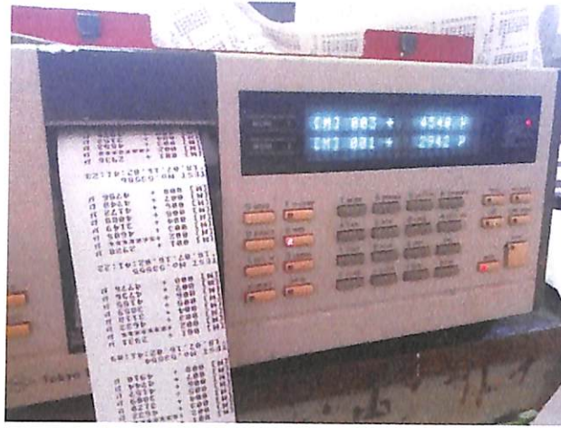
(e) บันทึกค่า Strain ที่เหลืออยู่ในเหล็กเสริมอัดแรงหลังจากตัดลวดแล้ว
