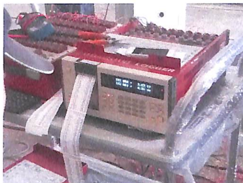
ภาพที่ 3.16 ให้น้ำหนักบรรทุกพร้อมกับบันทึกค่า Strain ของเหล็กเสริมอัดแรงและไม่อัดแรง
