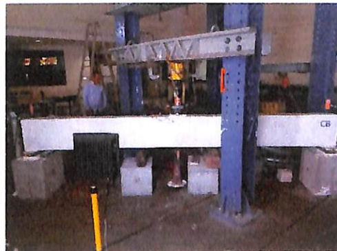
(b) ติดตั้ง Load Cell, Dial Gage และเครื่องมือวัดต่างๆ
