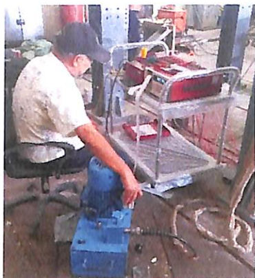
ภาพที่ 3.16 ให้น้ำหนักบรรทุกพร้อมกับบันทึกค่า Strain ของเหล็กเสริมอัดแรงและไม่อัดแรง
