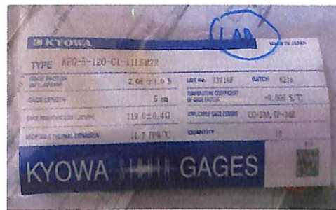
(a) Strain Gage ที่ใช้ติดกับผิวคอนกรีตและCFRP (b) Strain Gage ที่ใช้ติดกับผิวเหล็กเสริม
