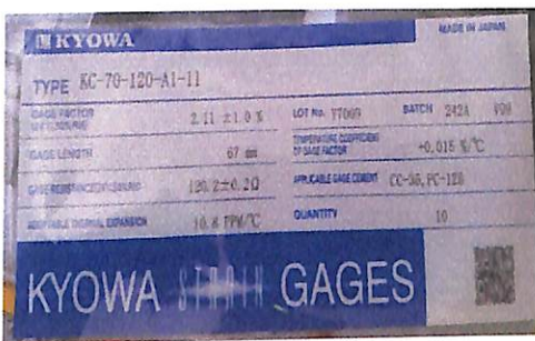
(a) Strain Gage ที่ใช้ติดกับผิวคอนกรีตและCFRP (b) Strain Gage ที่ใช้ติดกับผิวเหล็กเสริม
