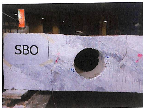
ภาพที่ 4.22 รูปแบบการวิบัติและรอยร้าวที่เกิดขึ้นของคาน SBO
