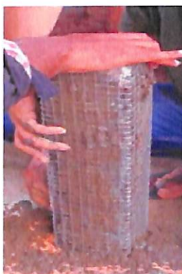
ภาพที่ 2.5 การเสริมกำลังด้วยวิธีเฟอร์โรซีเมนต์ให้กับเสาสั้น (Muhammed Salih et al., 2016)
