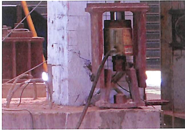
ภาพที่ 4.5 การวิบัติด้วยแรงเฉือนที่โคนเสาที่การเคลื่อนที่สัมพัทธ์ +0.40% (BF-SR)
