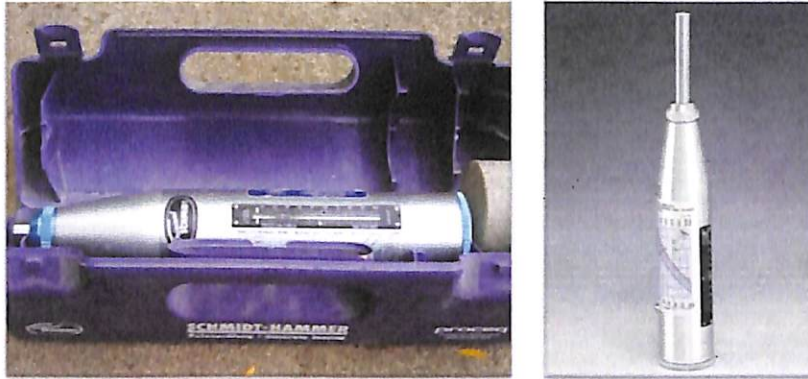
รูปที่ 2.1 แสดงเครื่องมือ Rebound Hammer ที่ใช้ในการทดสอบ
