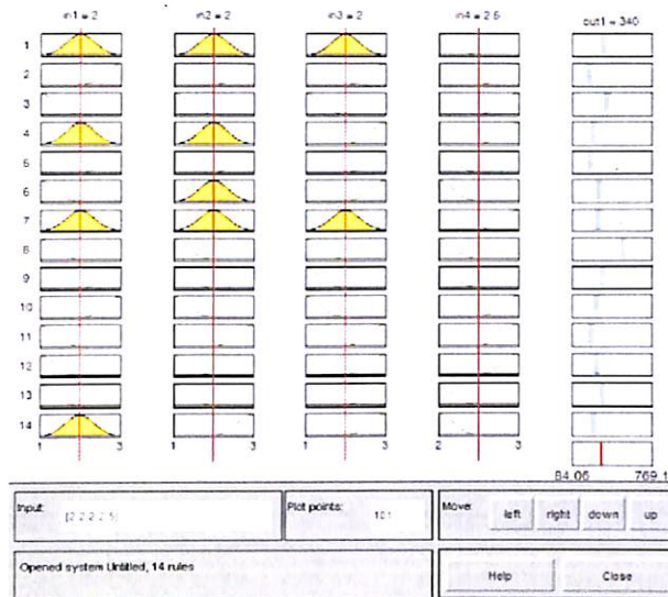
รูปที่ 3.9 แสดงการตรวจสอบความแม่นยำโดยใช้ Rule Viewer ที่ได้จากโมเดล
