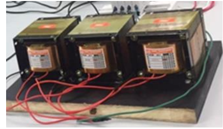
รูปที่ 2 หม้อแปลงไฟฟ้าสามเฟสที่ประกอบขึ้นจากหม้อแปลงไฟฟ้าเฟสเดียว
