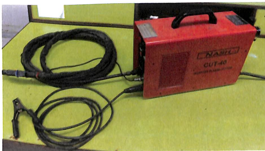
รูปที่ 4.1 เครื่องตัดพลาสมาแบบดั้งเดิมที่นำมาทดสอบ
