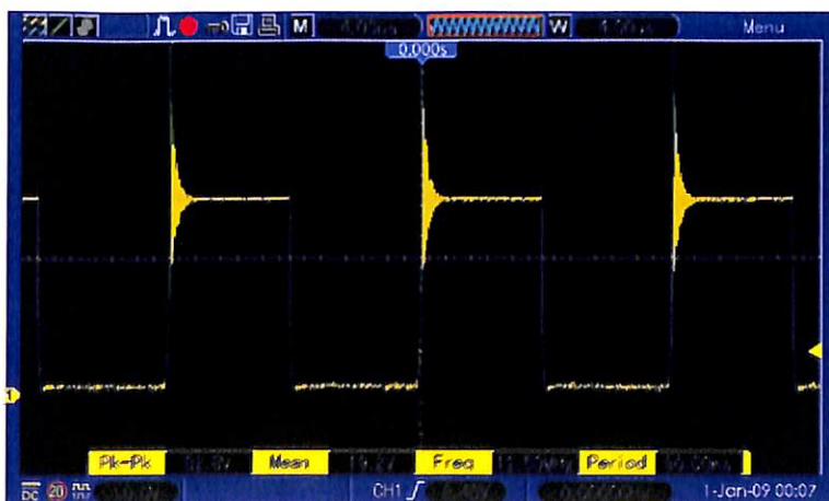
รูปที่ 4.22 แสดงสัญญาณ PWM ของขาคอลเลคเตอร์-อิมิตเตอร์
