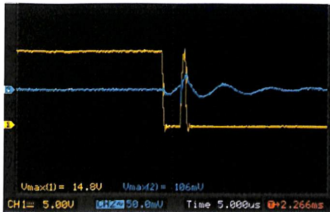
รูปที่ 4.18 แสดงรูปสัญญาณ PWM และ กระแสอินพุท( ลีฟ้า) ในขณะที่ตัดครั้งที่ 2
