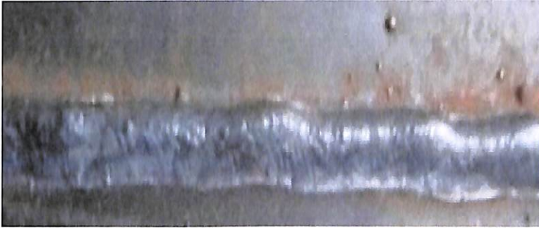
รูปที่ 4.28 รอยเชื่อมของเครื่องเชื่อมที่สร้างขึ้น ก่อนการติดตั้ง
