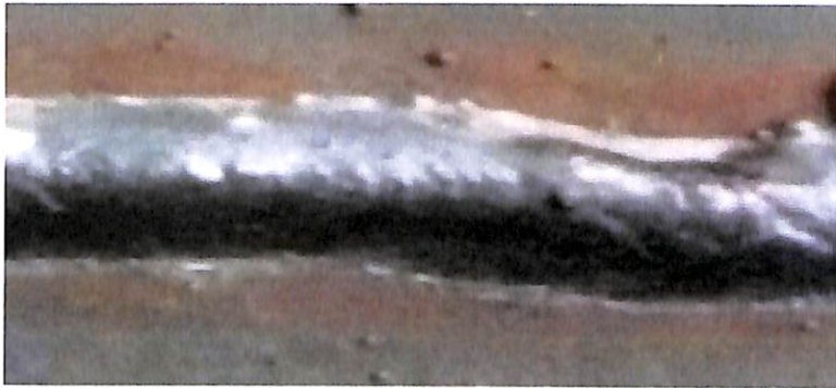
ข. รอยเชื่อมที่เกิดขึ้นจากการติดตั้งวงจร Valley Fill แบบที่ 2 ที่ DC Bus
