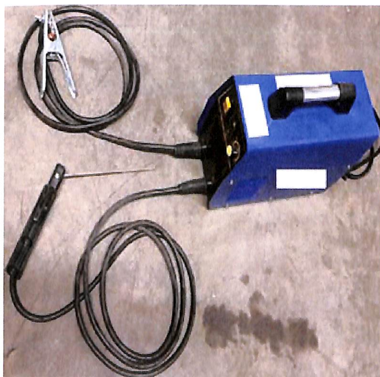
ก. รูปตัวอย่างเครื่องเชื่อมไฟฟ้าที่ใช้ในงานอุตสาหกรรมทั่วไป
