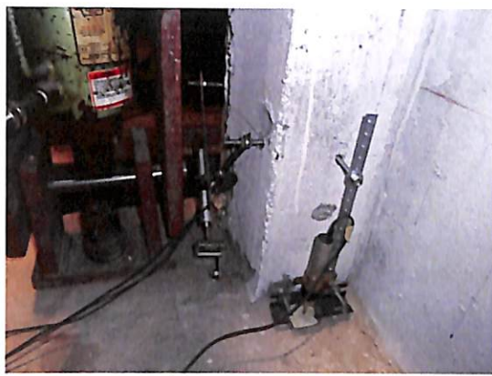
LVDT ฝั่งเสาด้านขวา
