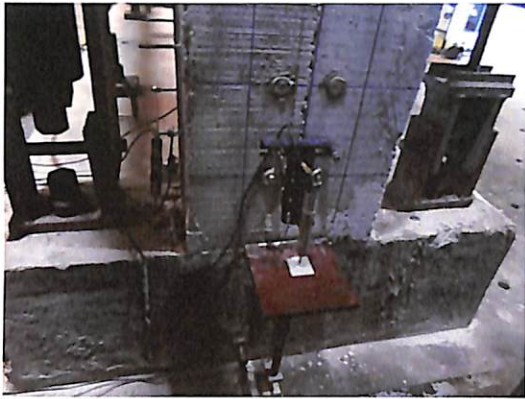
LVDT ฝั่งเสาด้านซ้าย
