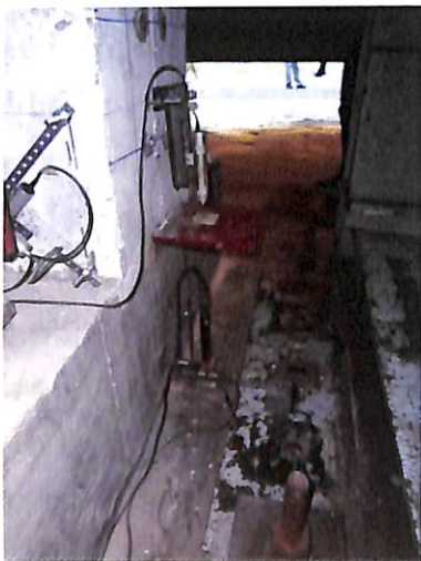
LVDT ฝั่งเสาด้านซ้ายล่าง
