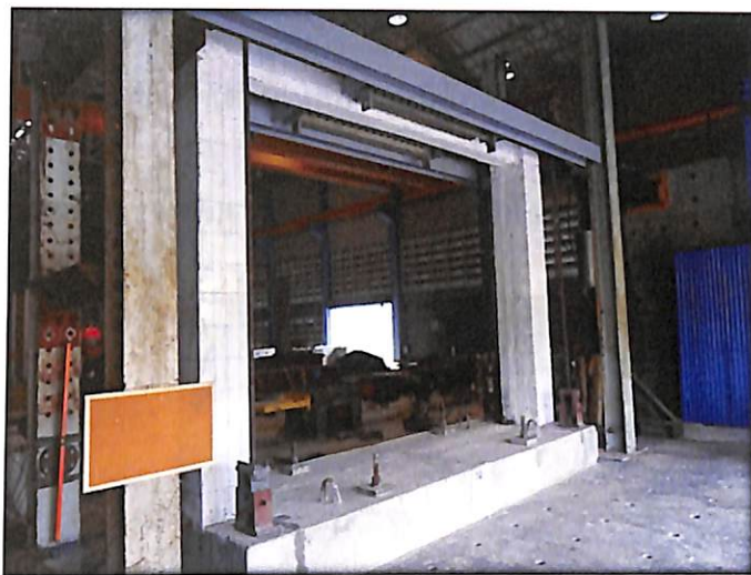
รูปที่ 4.7 โครงข้อแข็งเปล้า (BF)
