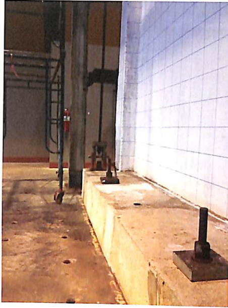
รูปที่ 4.28 การยัดฐานโครงข้อแข็งเข้ากับพื้นที่ทดสอบด้วยการโพสเทนชั่น
