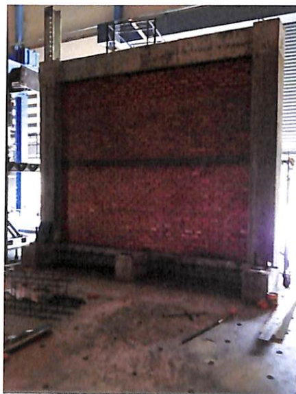
รูปที่ 4.25 ผนังอิฐก่อในโครงสร้างข้อแข็งคอนกรีตเสริมเหล็ก
