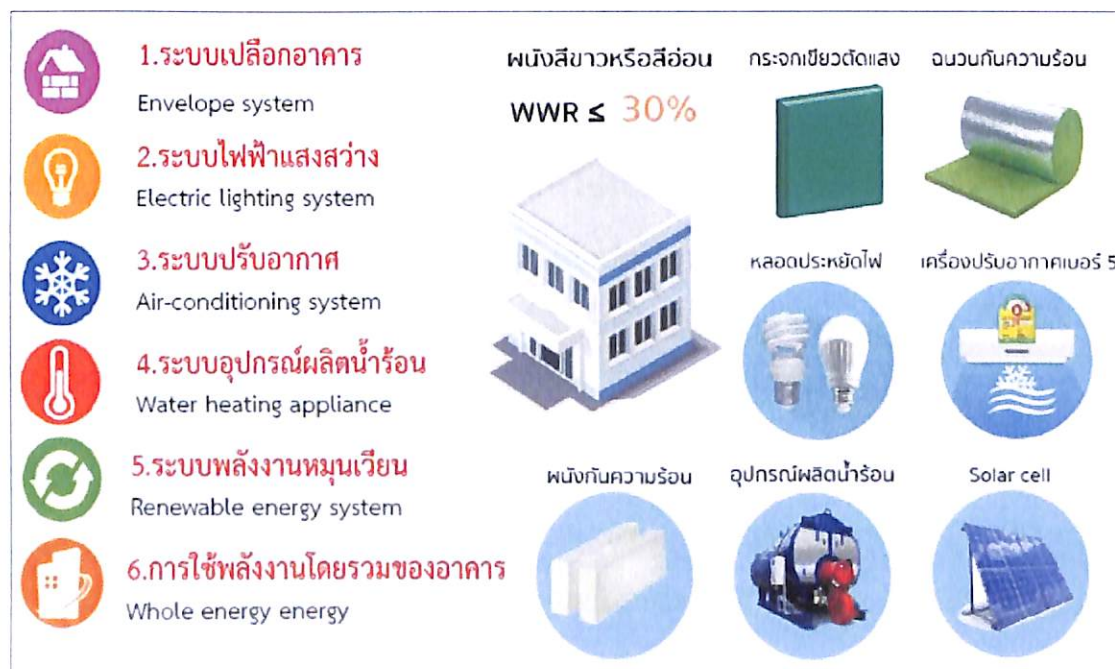
รูปที่ 2.5 แสดงเกณฑ์ประสิทธิภาพพลังงานขั้นต่ำ
