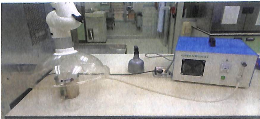
รูปที่ 3.7 แสดงการต่อเครื่องกำเนิดไอโชนเข้ากับอุปกรณ์การทดลอง
