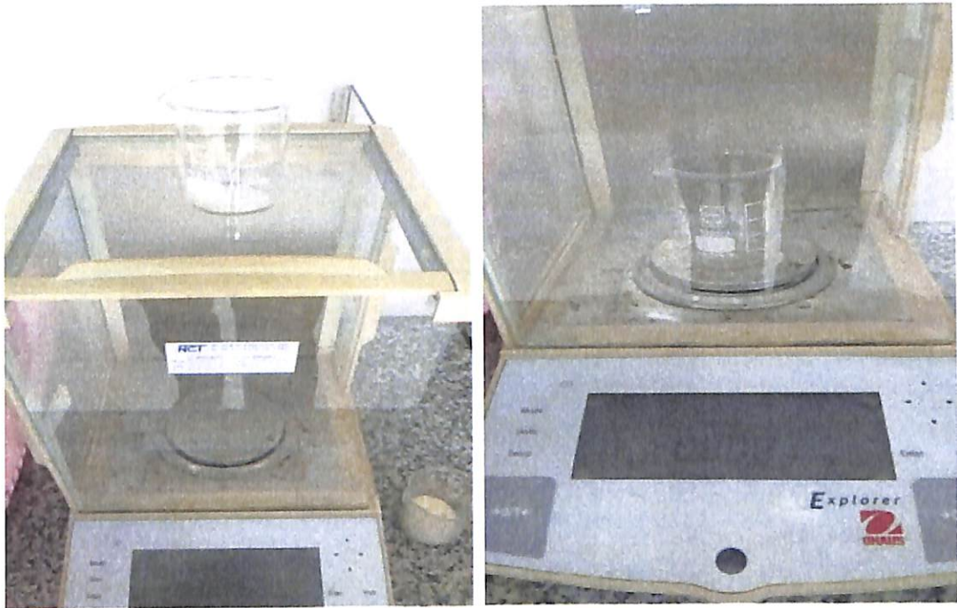
รูปที่ 3.4 เครื่องชั่งน้ำหนักแบบความเที่ยงตรงสูง Precision Balances ความละเอียดทศนิยม 4 ตำแหน่ง
