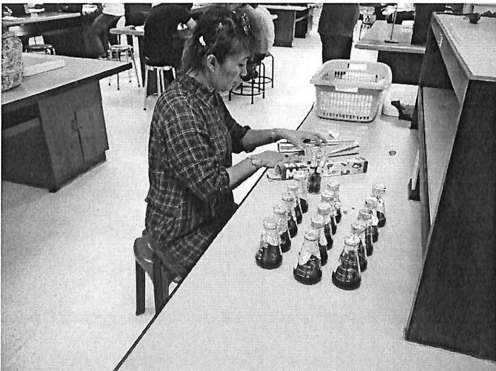
รูปที่ 3.11 การเตรียมการวิเคราะห์โดยวิธีของ Boehm สำหรับหาหมู่ฟังก์ชันหลังการเขย่า
