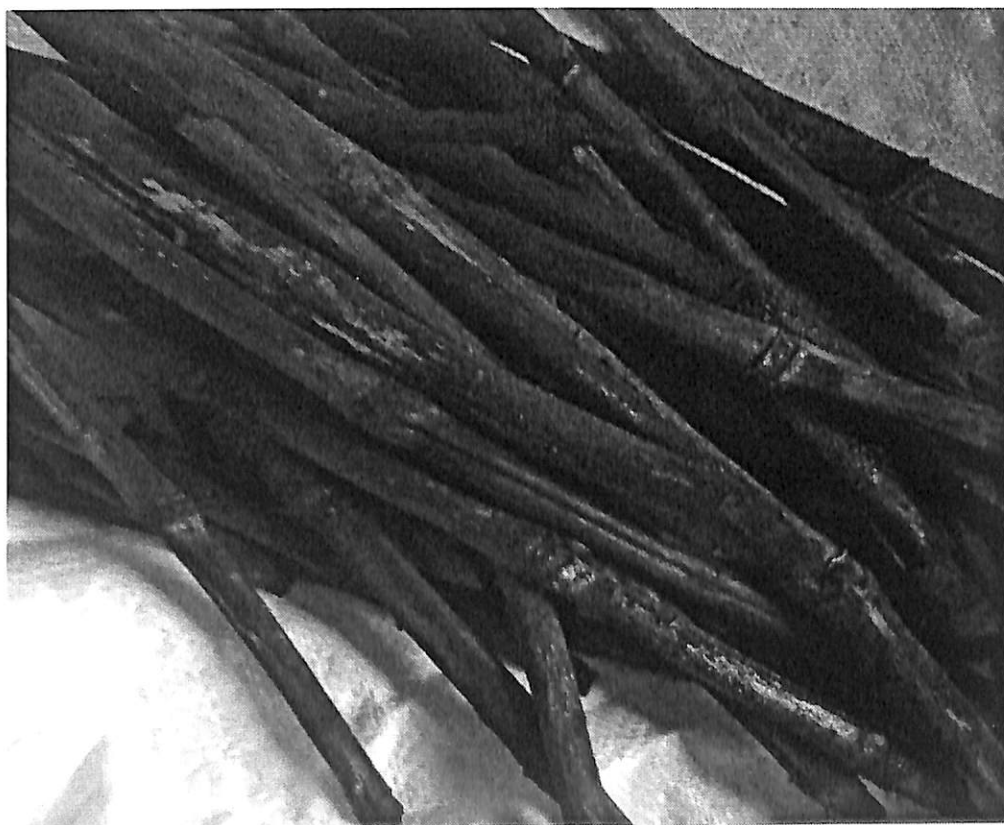
รูปที่ 3.5 ถ่านที่ได้จากหญ้าเนเปียร์เขียวสยาม
