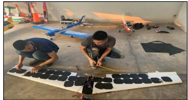
รูปที่ 2 การติดตั้งโซลาร์เซลล์ลงบนอากาศยานไร้คนขับ
