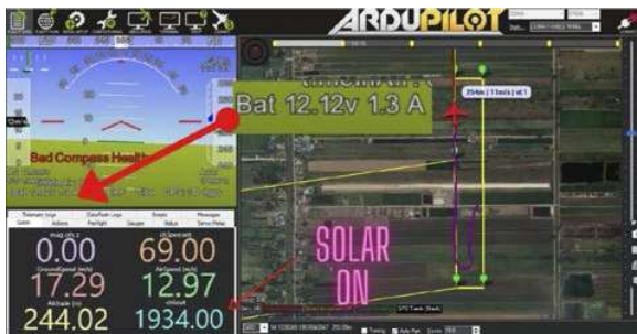
รูปที่ 14 หน้าต่างโปรแกรมระบบควบคุมการบินอัตโนมัติโดยเปิดระบบรับพลังงานจากโซลาร์เซลล์
