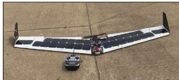
รูปที่ 3 อากาศยานไร้คนขับที่ติดตั้งเรียบร้อยแล้วพร้อมทำการบิน
