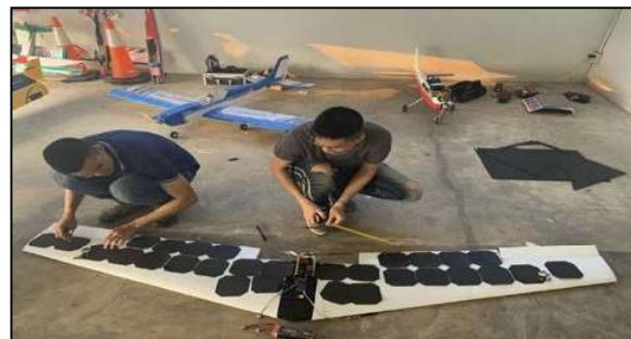
รูปที่ 2 การติดตั้งโซลาร์เซลล์ลงบนอากาศยานไร้คนขับ
