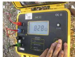
ก) เครื่องวัดความต้านทานดินที่ความถี่กำลัง
