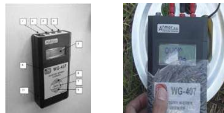
ข) เครื่องทดสอบความต้านทานดินอิมพัลส์ WG-407
