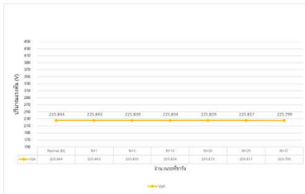
รูปที่ 13 แสดงแรงดันเฟสที่ปลายสายที่ใช้ในการชาร์จ EV ของหม้อแปลง 250 kVA
