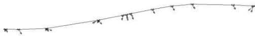
รูปที่ 6 แสดง Single Line Diagram ระบบจำหน่ายแรงต่ำของหม้อแปลง 160 kVA
