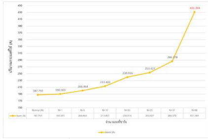
รูปที่ 12 กราฟแสดงค่ากระแสที่ใช้ในการชาร์จยานยนต์ EV ของหม้อแปลง 250 kVA
