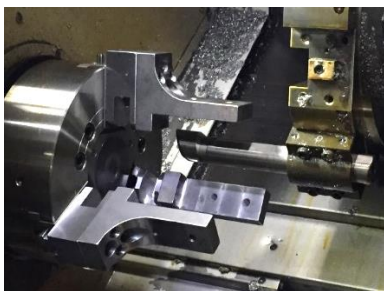
ภาพที่ 6 แสดงภาพการกลึงตั้งศูนย์ Jig กับเครื่อง CNC
