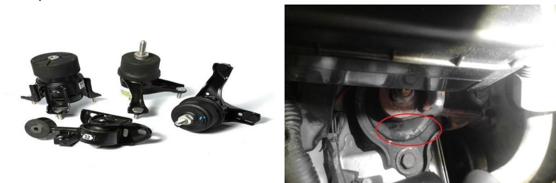
รูปที่ 1 แสดงตัวอย่างของยางรองแท่นเครื่องและการเสื่อมสภาพของยางรองแท่นเครื่องรถยนต์
