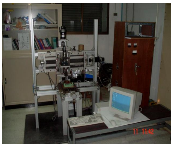
รูปที่ 9 ภาพรวมของเครื่องกัดซีเอ็นซี ชนิด 3 แกน
