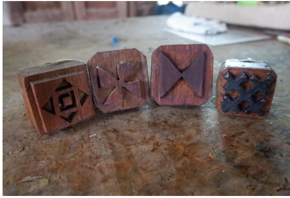
ภาพที่ 47 แม่พิมพ์ไม้ สำหรับพิมพ์ลายผ้าหม้อห้อม
