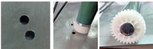
รูปที่ 8 ลักษณะตัวอย่างแผ่นโลหะตัวนำที่มีช่องเปิดและการนำหัววัดไปทดสอบ
