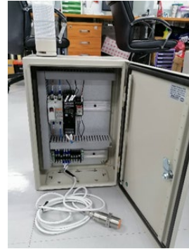
รูปที่ 6 ตู้อุปกรณ์ตรวจจับผงซักฟอกบนรางลำเลียง
