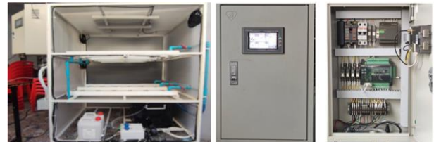
รูปที่ 5 โครงสร้างชั้นเพาะปลูกพืช และตู้ควบคุมระบบปลูกพืชไฮโดรโปนิคส์ด้วยพีแอลซี
